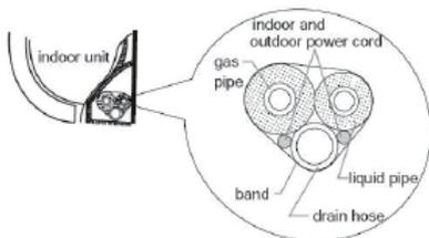
2. 當包裹排水軟管和電源線時，保留一定長度的給安裝。當包裹到一定程度，分開室內電源，然後分開排水軟管。
