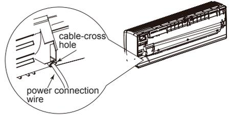
3. 拆下線夾；電源連接線根據顏色連到接線端子；擰緊螺絲，然後固定電源連接線與線夾。
