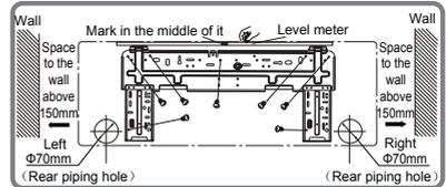
2. 在已選擇的去水管位置打開  $\Phi 55$  或  $\Phi 70$  直徑的管道孔。為了暢順地排水，把牆壁上的管孔向室外側略微向下傾斜  $5-10^\circ$  梯度。
