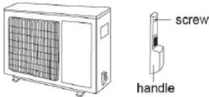
2. 拆下閥門的螺絲帽，對準管道接頭在管道的喇叭口。
